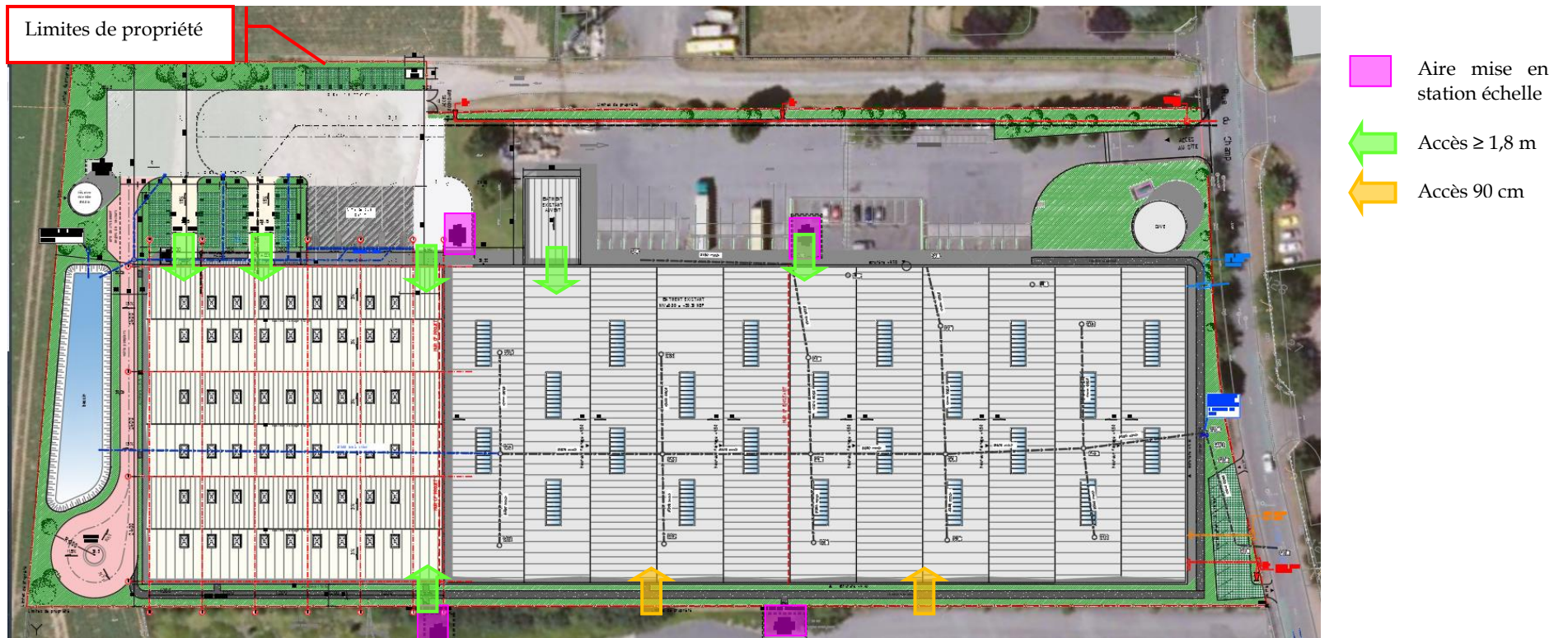
Figure 8 : Accès aux cellules
