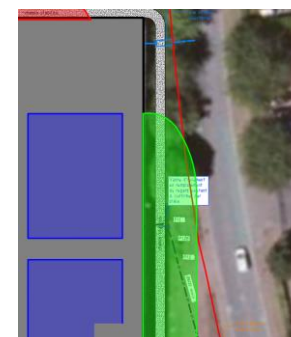
Dépassement des SEI côté rue du champ de tir
