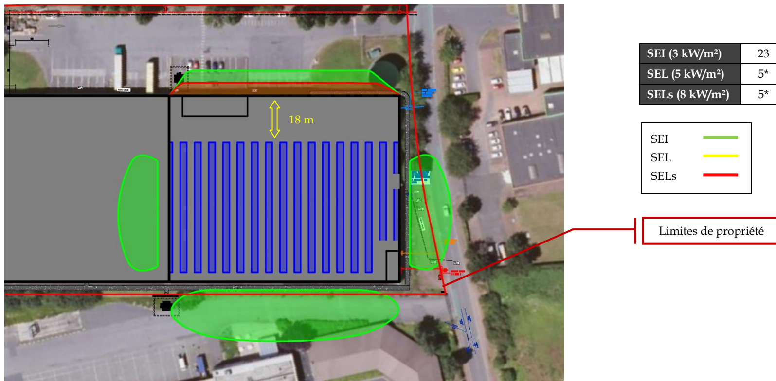
Figure 39 : Scenario 10 - Incendie cellule 1 - Stockage en racks de sièges à 6 m de hauteur
