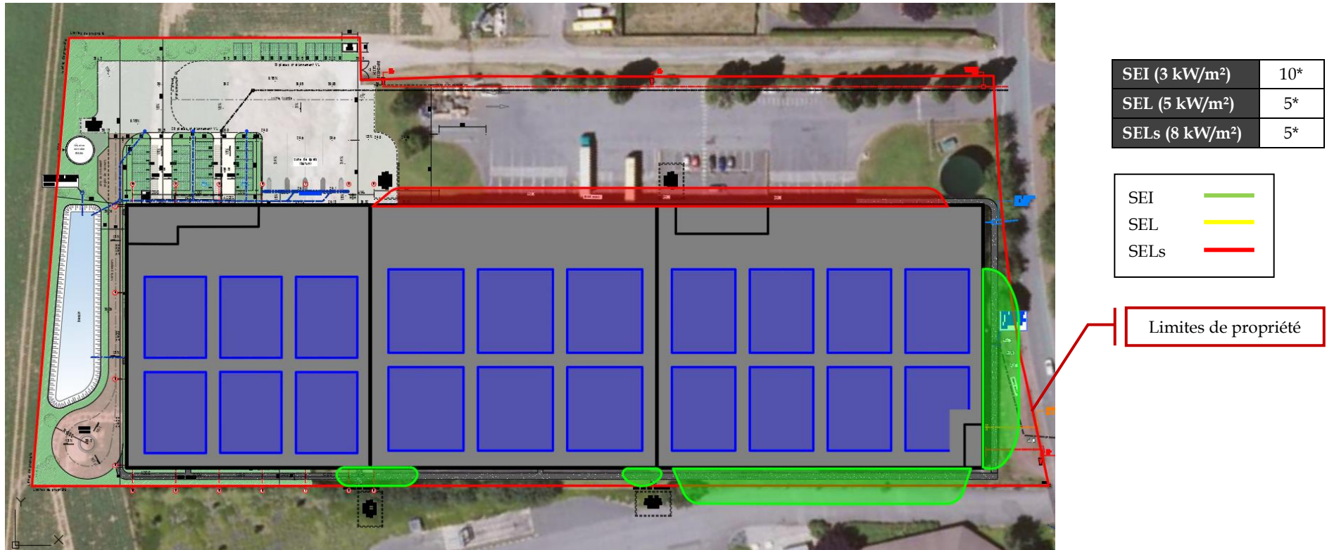
Figure 51 : Scenario 22 – Incendie généralisé – Stockage en masse de pneus (6 à 7 m de hauteur)
